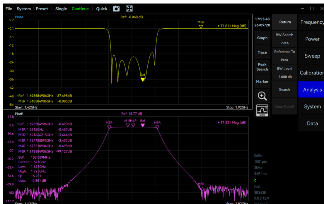
图 3 带通滤波器 S 参数测量结果
