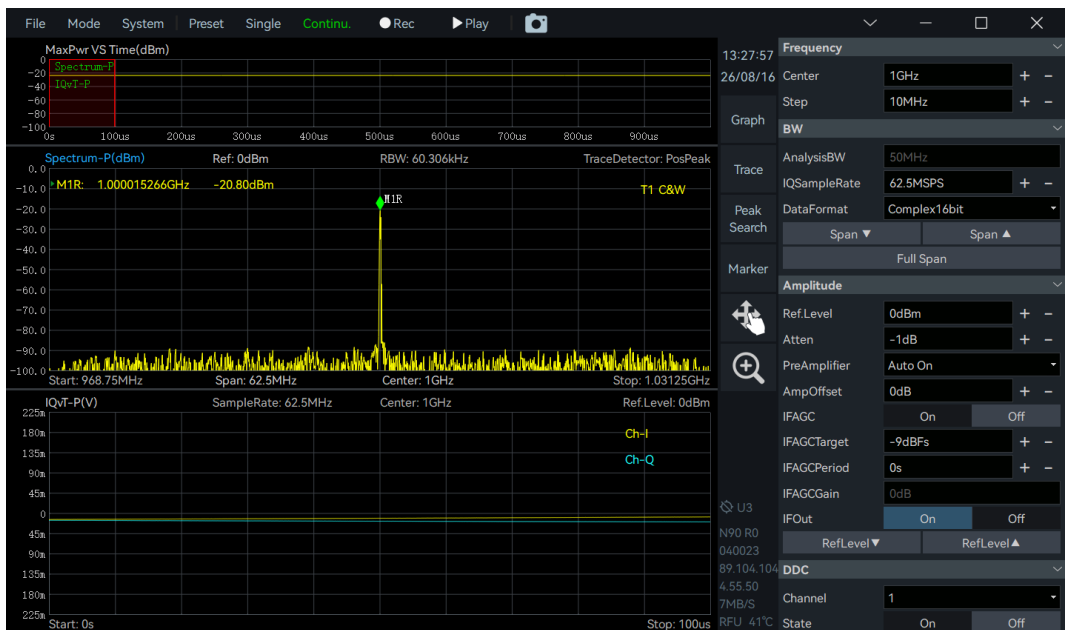
图 8-2 R1090 射频接收机的 IQ 流测试结果
