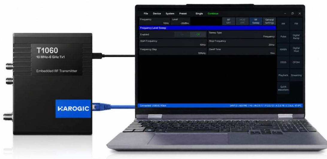
图 5-1 T1000 系列设备连接图
