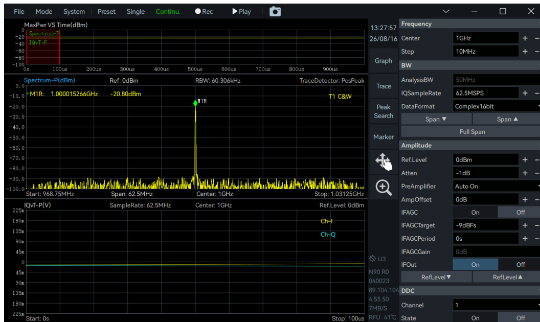
图 8-1 R1090 射频接收机的 IQ 流测试结果
