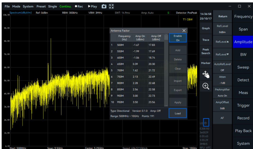
图 31 搭配 HDA-100：自动加载天线因子
