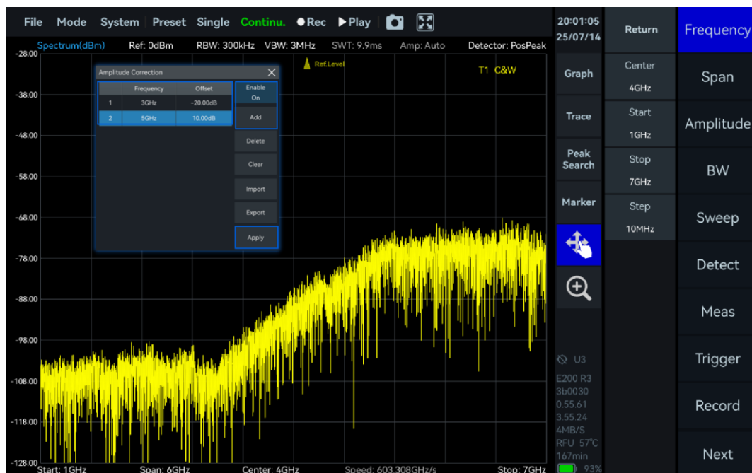
图 20 幅度修正应用
