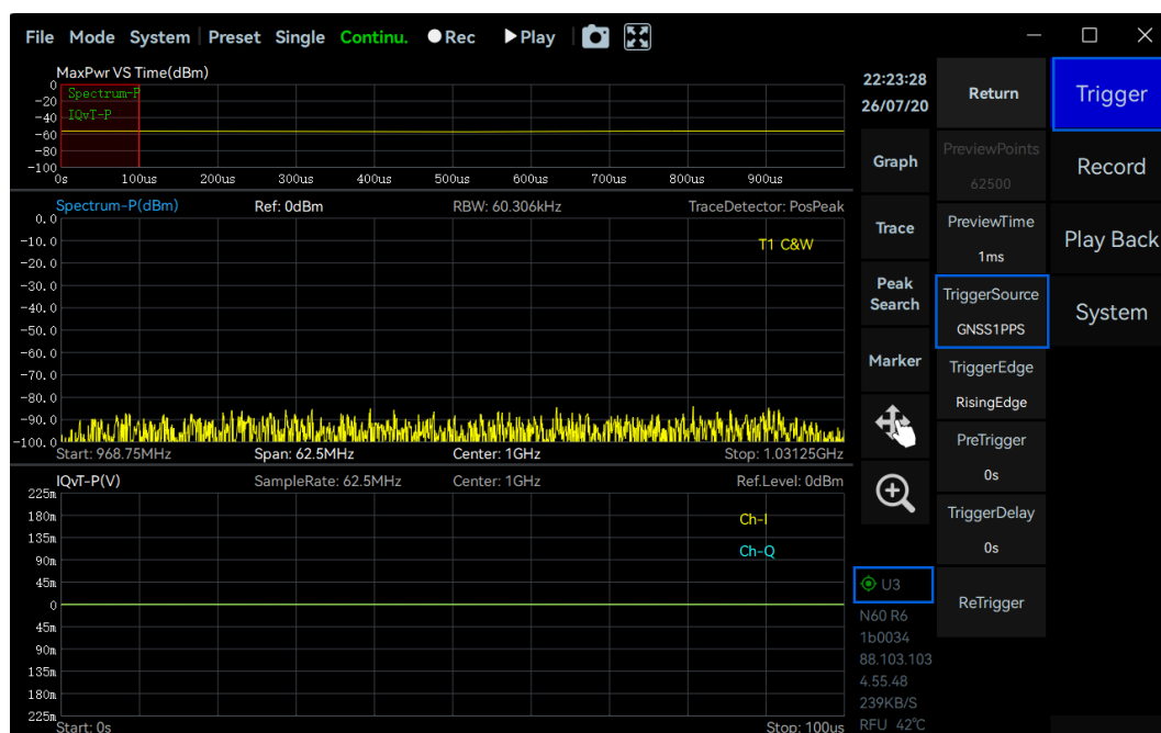
图 8 使用 GNSS 1 PPS 触发
