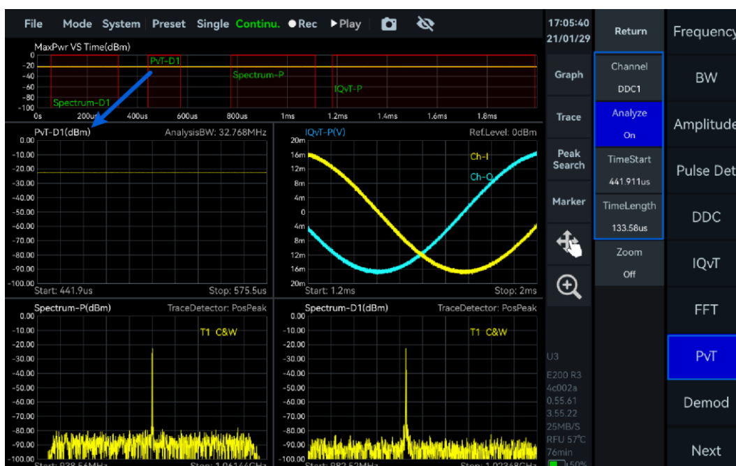
图 38 查看 DDC 下 IQ 子流的功率-时间图
