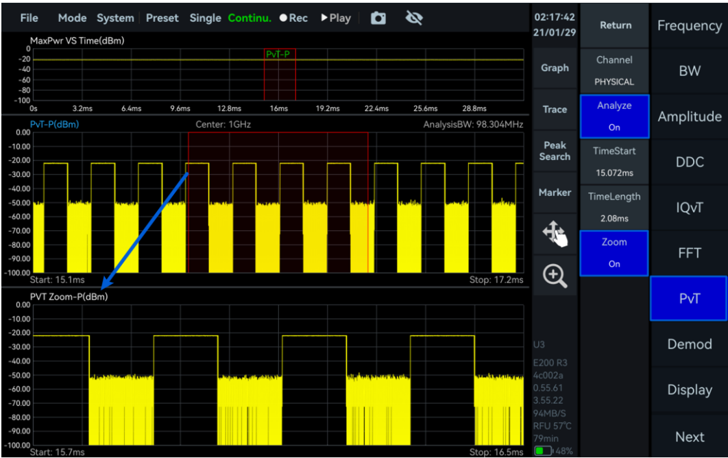
图 33 IQ 数据功率-时间图及其放大图
