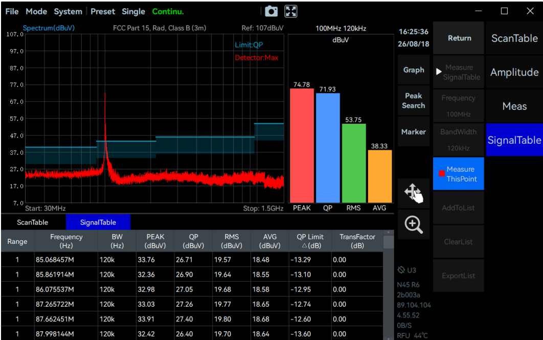
图 51 EMI 预兼容测量示意
