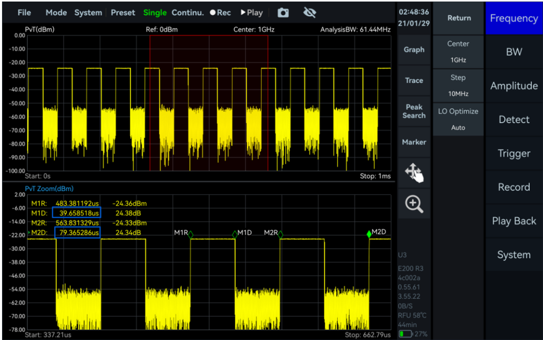
图 39 脉冲信号周期和脉宽测量
