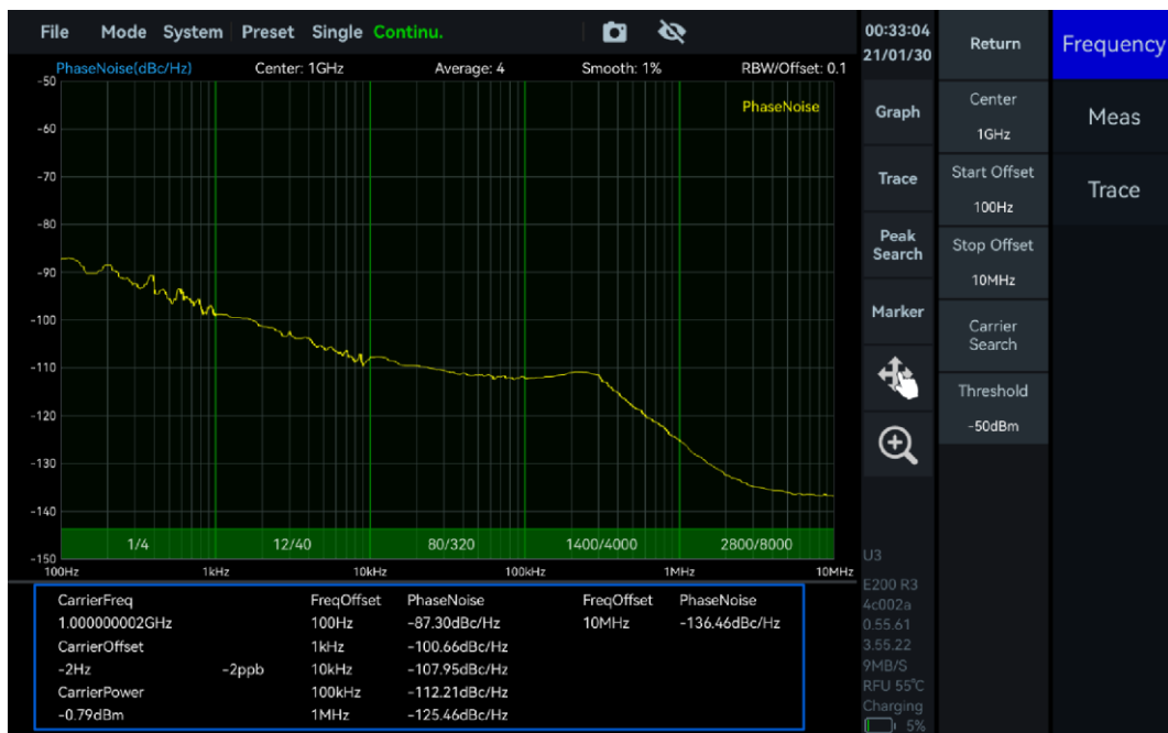
图 44 相位噪声测量结果
