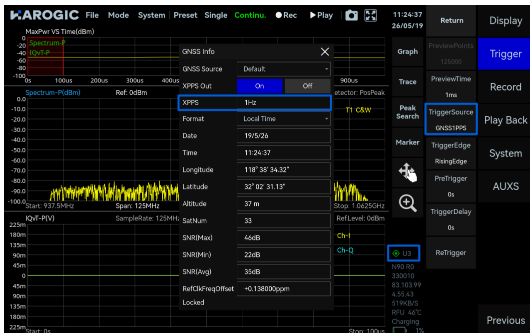
图 6 使用 GNSS 1 PPS 触发
