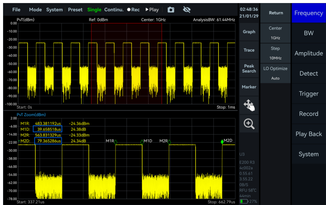
图 37 脉冲信号周期和脉宽测量
