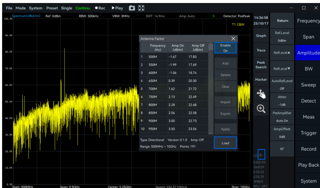
图 28 搭配 HDA-100：自动加载天线因子
