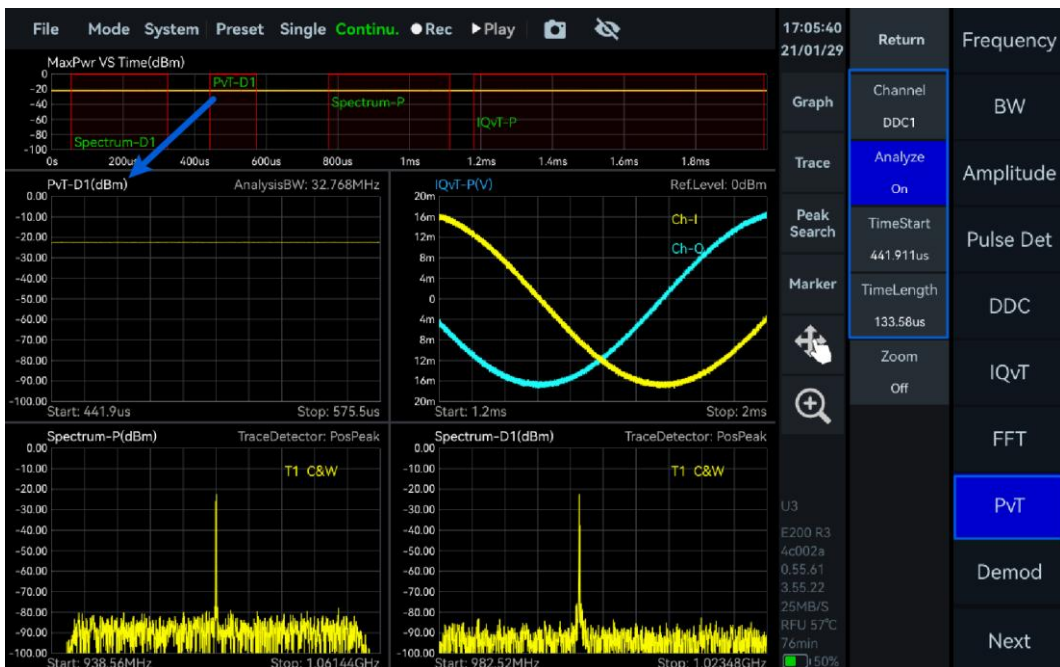
图 36 查看 DDC 下 IQ 子流的功率-时间图
