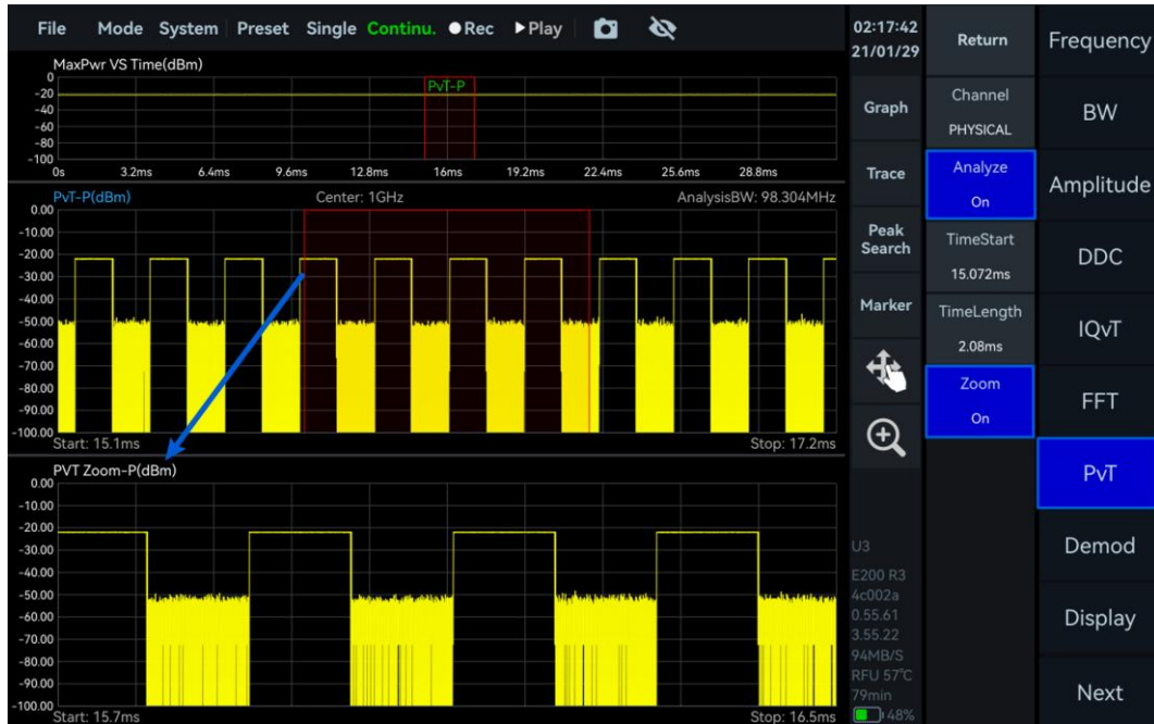
图 31 IQ 数据功率-时间图及其放大图
