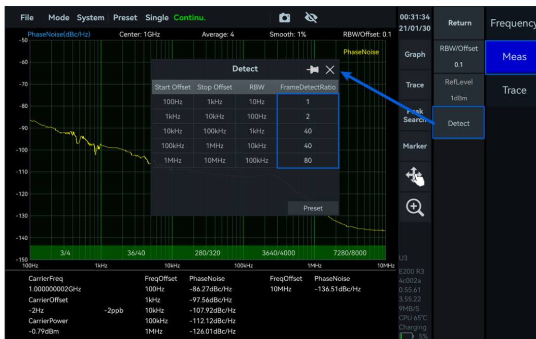
图 43 脉冲信号检测检波设置
