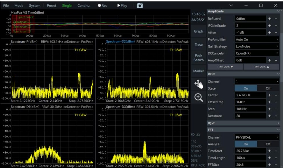
图 9-1 DDC 通道不同抽取倍数对比（外接天线）
