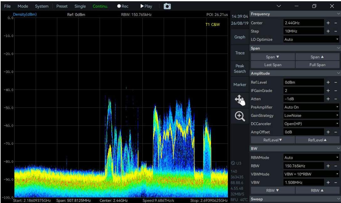
图 7-1 设置为 2.44GHz 中心频率，SMA 端口连接天线的实时频谱分析结果
