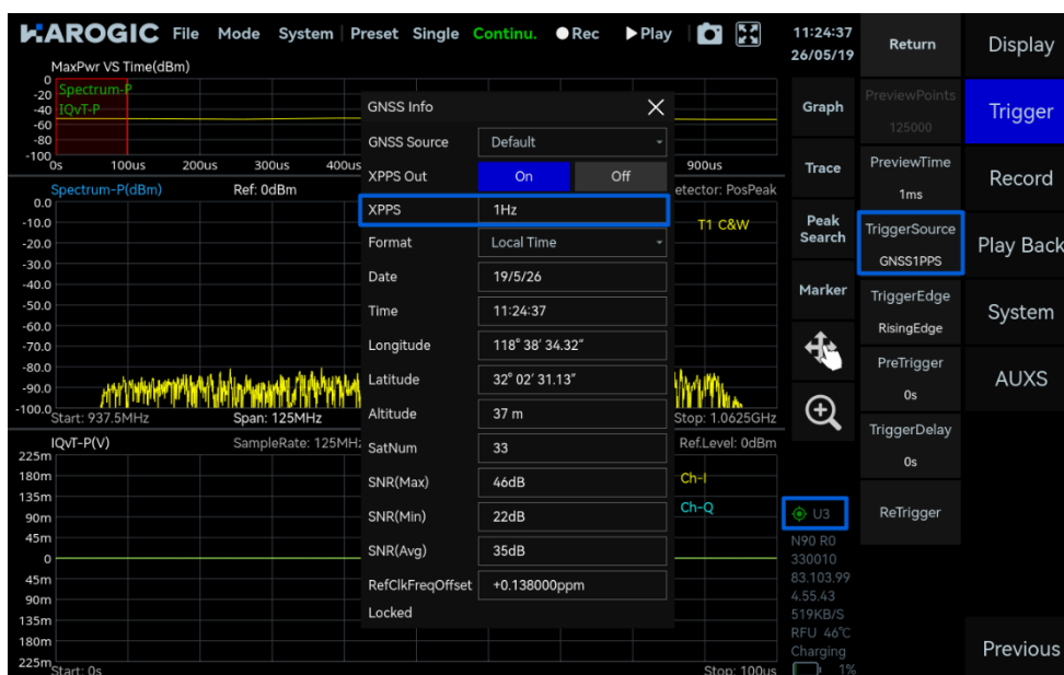
图 12-4 使用 GNSS 1 PPS 触发
