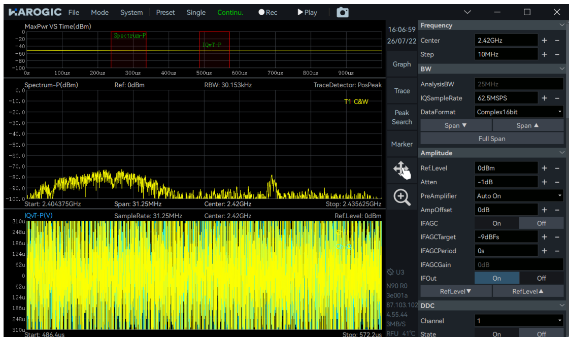
图 8-3 接收机 IQ 流模式中的频谱和 IQ 时域波形
