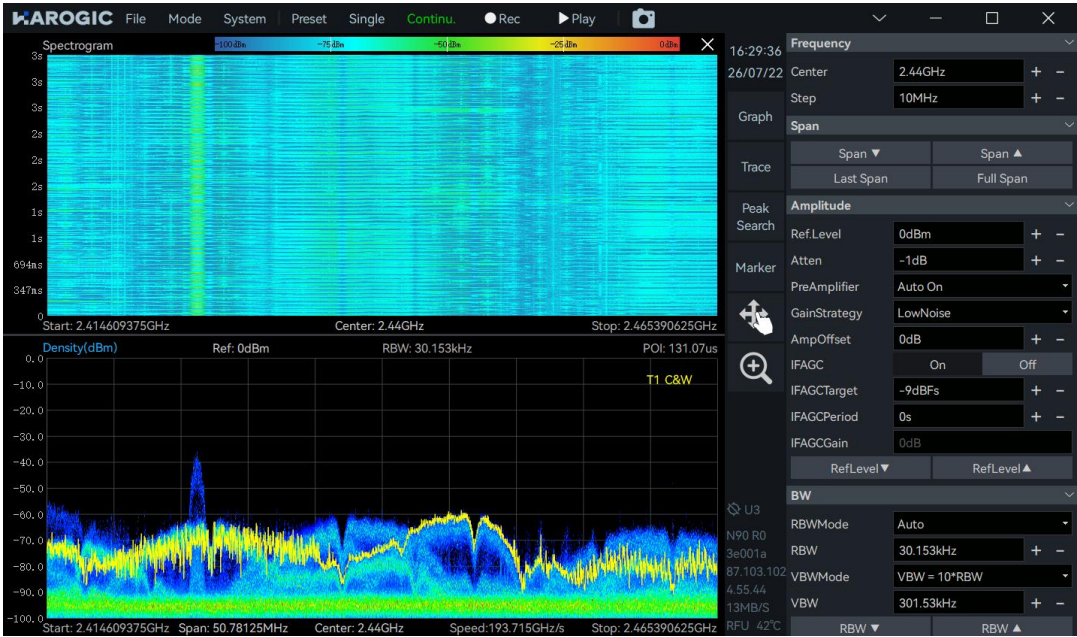
图 10-1 实时频谱模式中的瀑布图和余晖图显示
