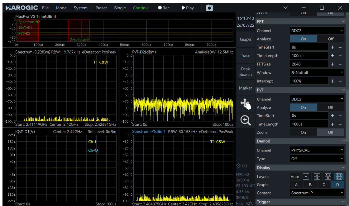
图 8-5 接收机 IQ 流模式中的 DDC 多通道目标子带分析
