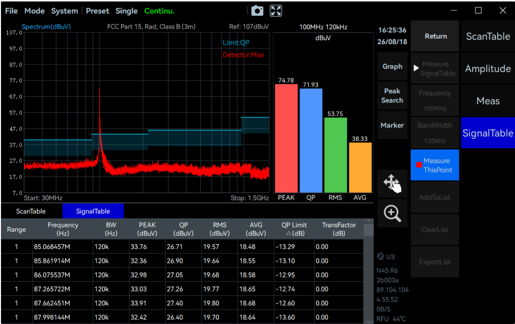
图 51 EMI 预兼容测量示意
