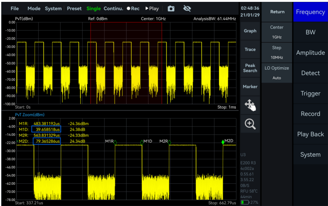
图 39 脉冲信号周期和脉宽测量
