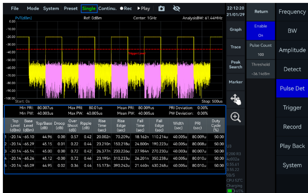
图 35 脉冲检测结果
