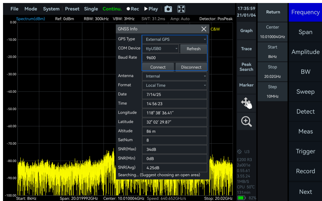
图 8 连接外部 GNSS 模块
