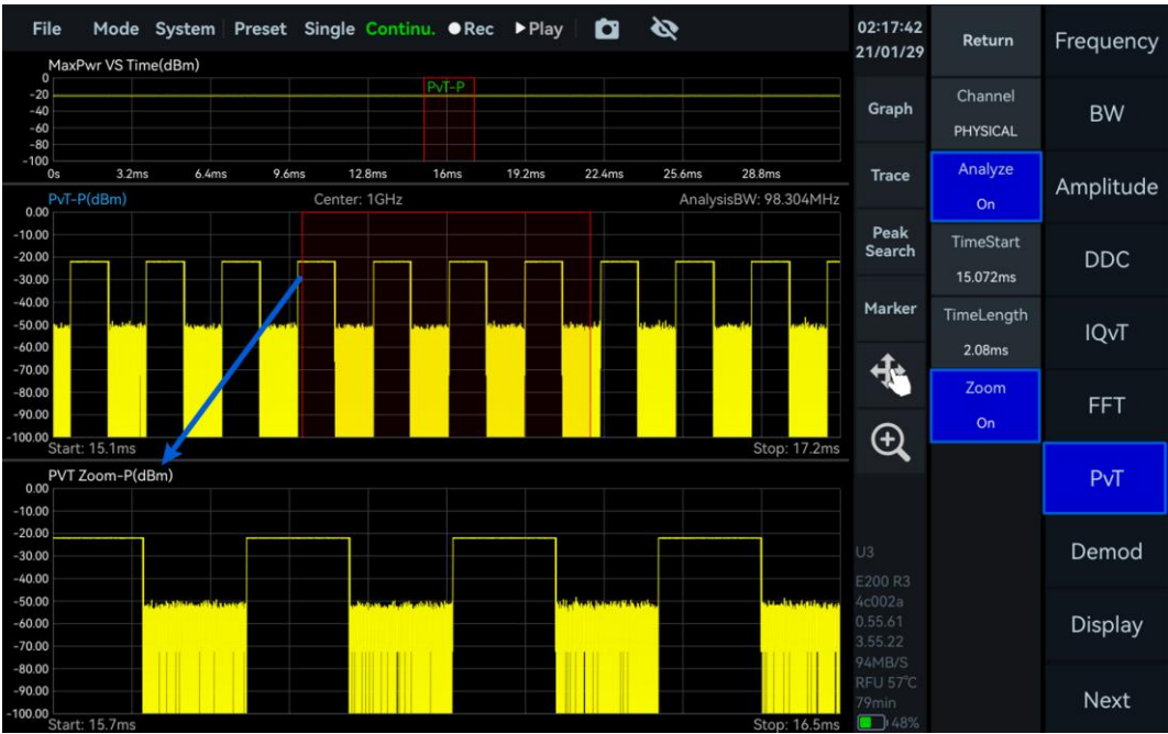
图 28 IQ 数据功率-时间图及其放大图
