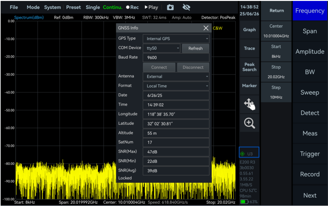
图 5 锁定 GNSS 外部天线
