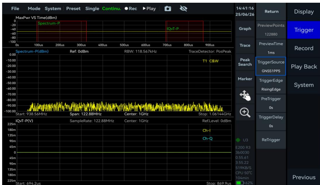
图 6 使用 GNSS 1 PPS 触发
