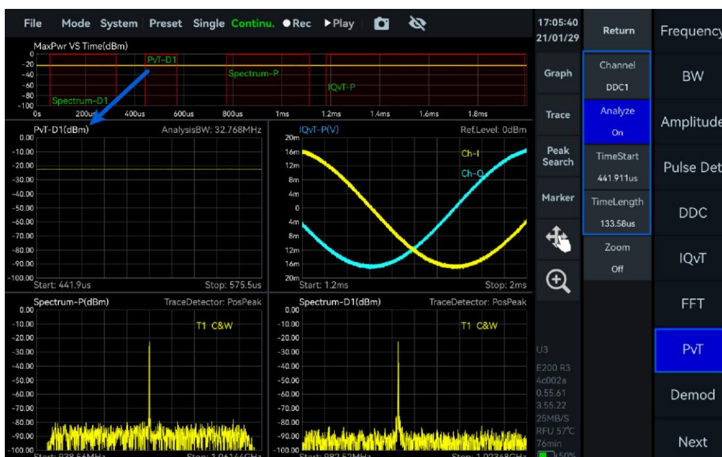
图 33 查看 DDC 下 IQ 子流的功率-时间图
