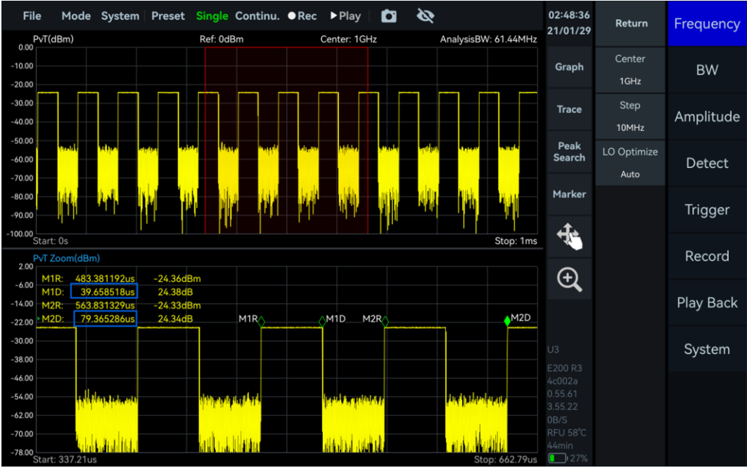
图 34 脉冲信号周期和脉宽测量
