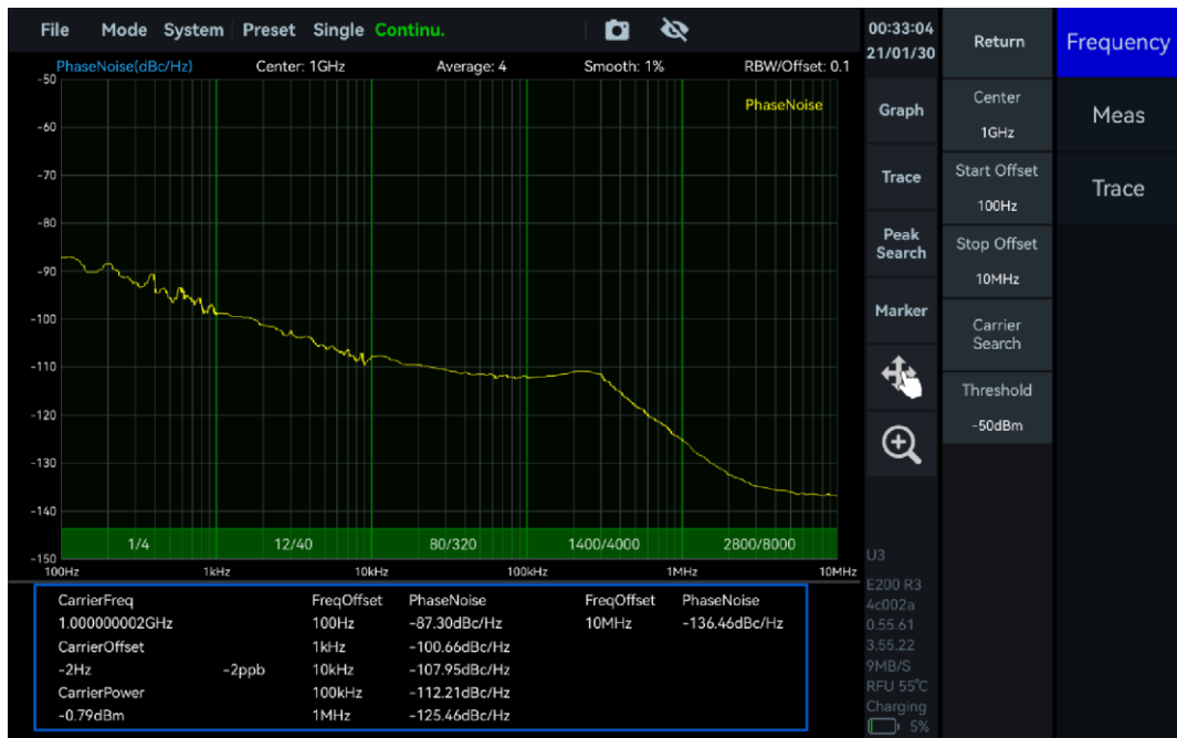
图 41 相位噪声测量结果
