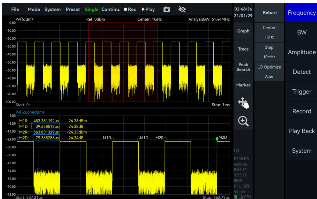
图 34 脉冲信号周期和脉宽测量
