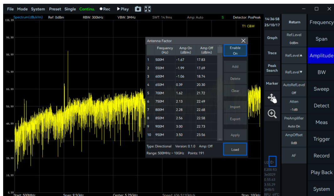
图 25 搭配 HDA-100：自动加载天线因子
