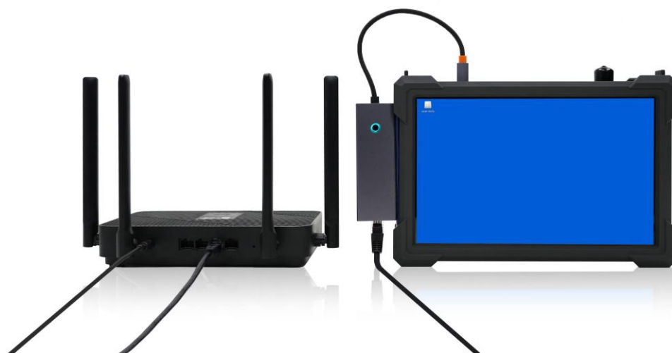
图 24 连接路由器与仪器
