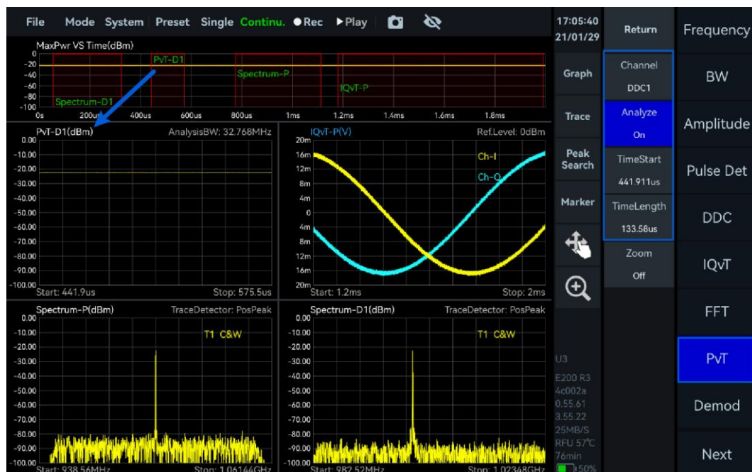
图 30 查看 DDC 下 IQ 子流的功率-时间图
