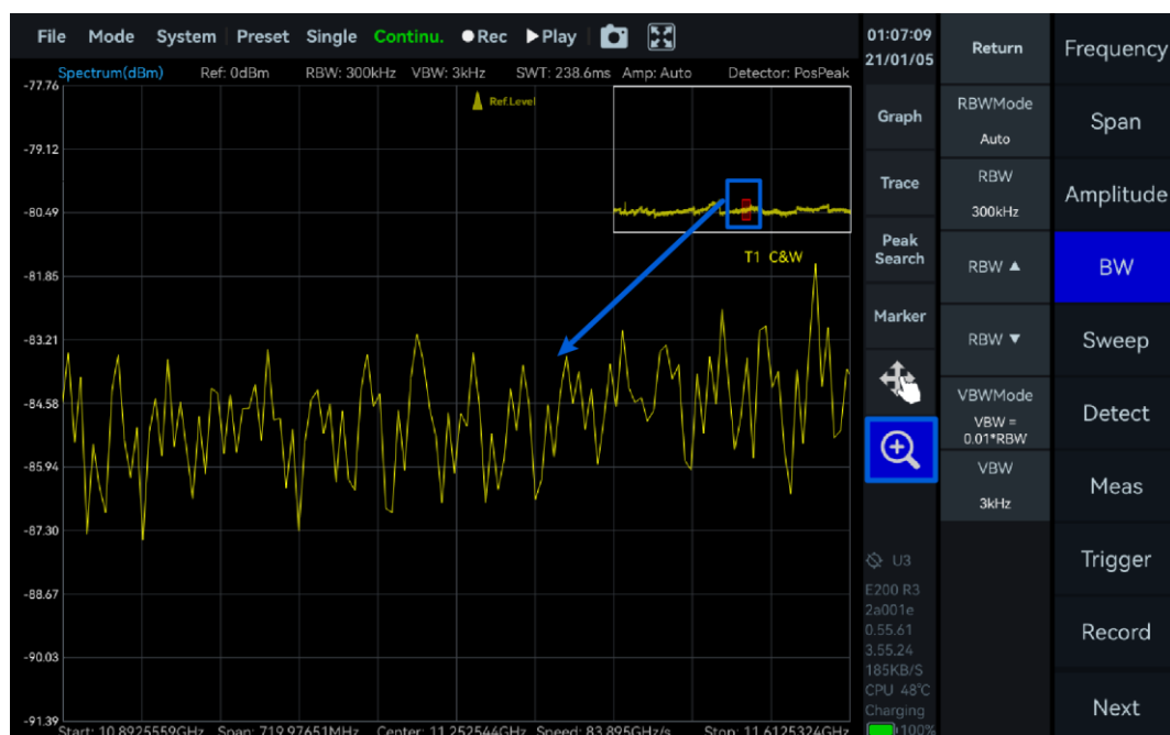
图 11 SWP 模式下放大镜放大
