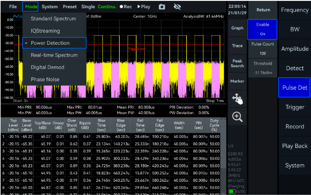
图 36 启用脉冲信号检测功能
