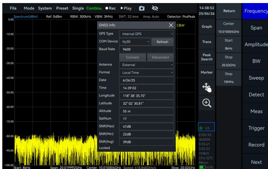
图 16 锁定 GNSS 外部天线
