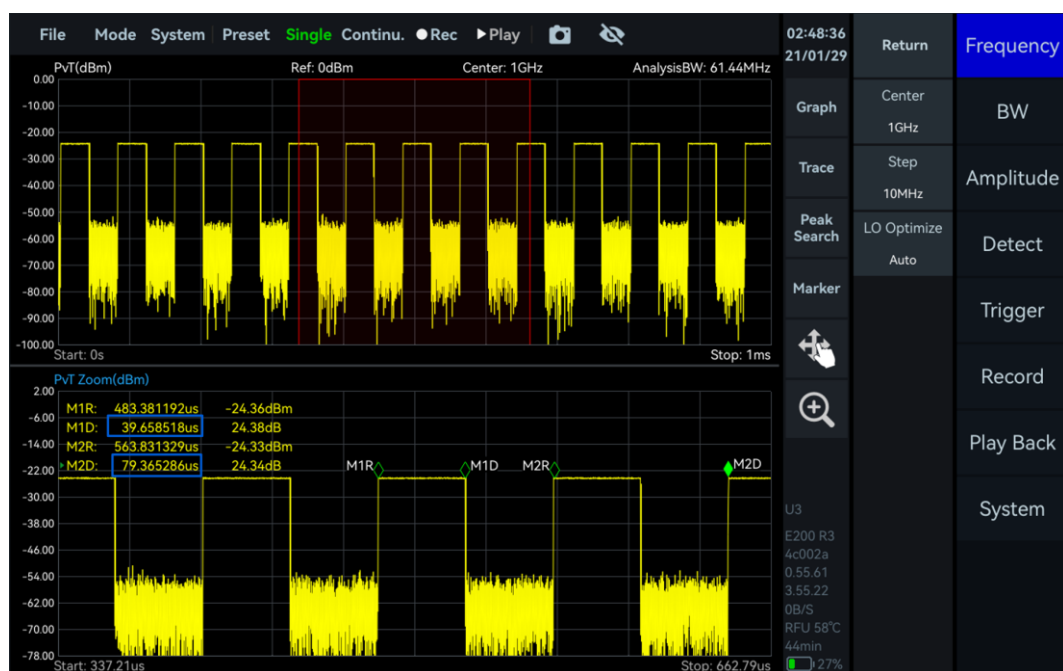
图 34 脉冲信号周期和脉宽测量
