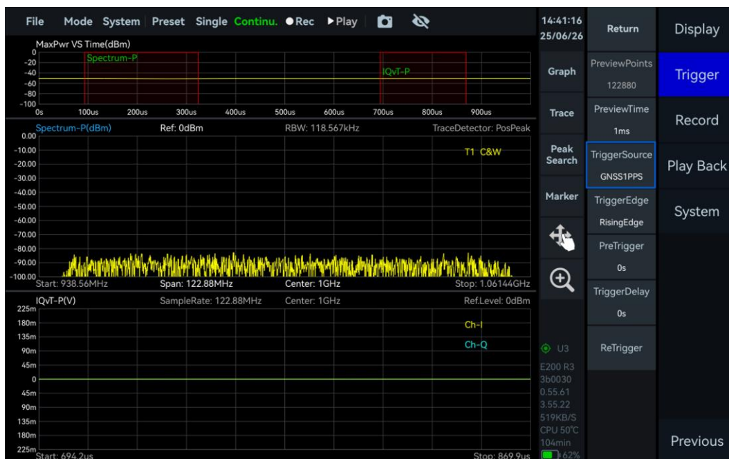
图 17 使用 GNSS 1 PPS 触发
