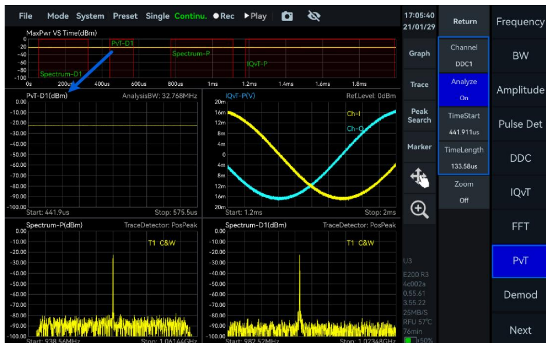
图 33 查看 DDC 下 IQ 子流的功率-时间图
