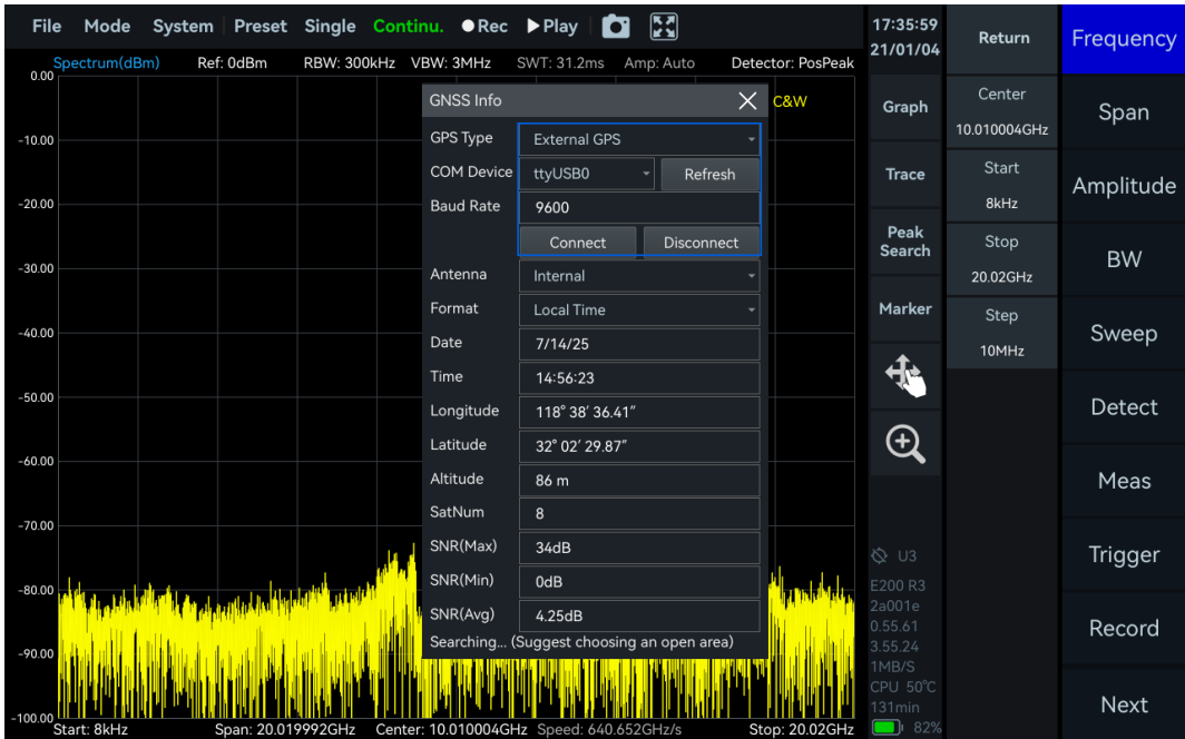
图 14 连接外部 GNSS 模块
