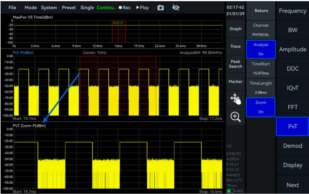
图 28 IQ 数据功率-时间图及其放大图
