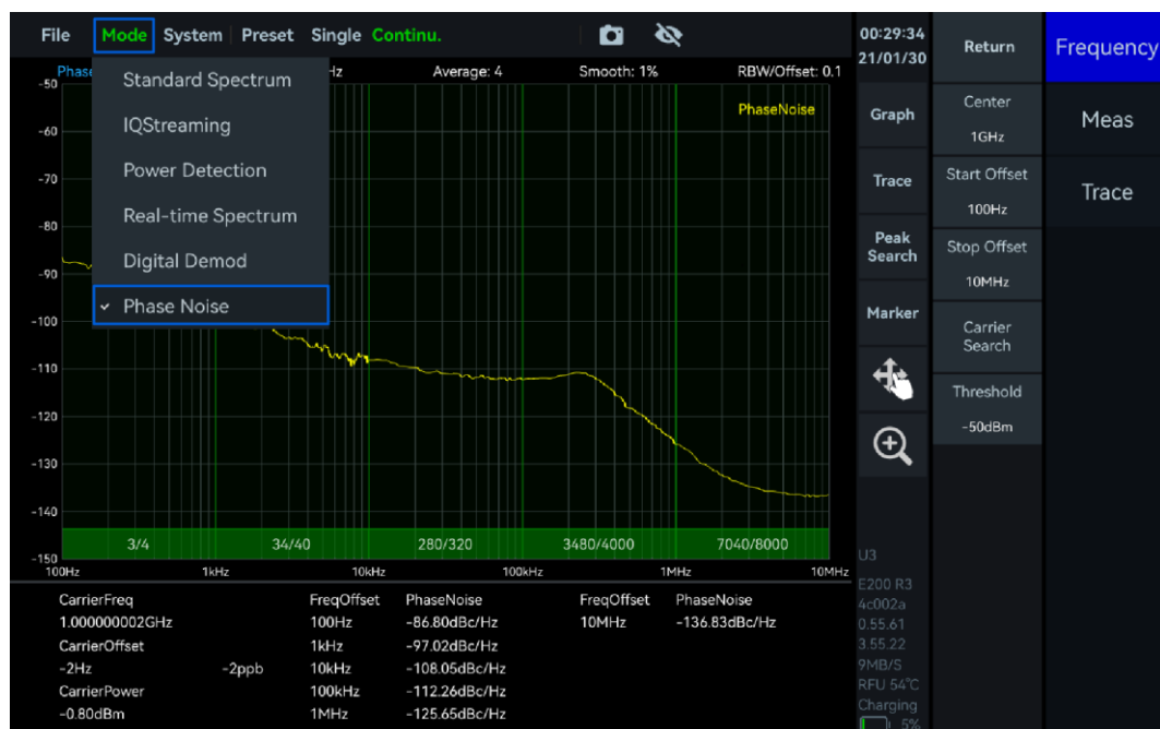
图 42 启用相位噪声测量功能
