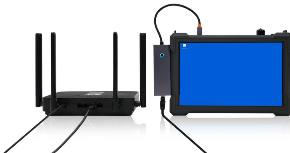
图 54 连接路由器与仪器
