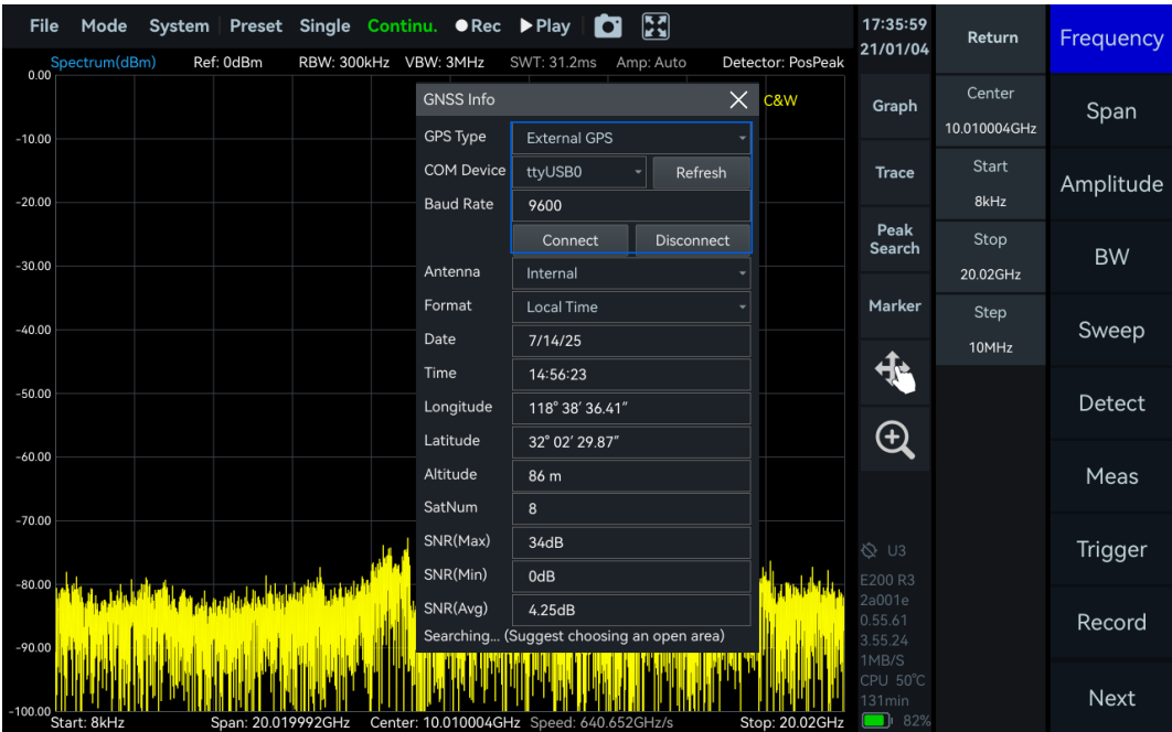
图 14 连接外部 GNSS 模块
