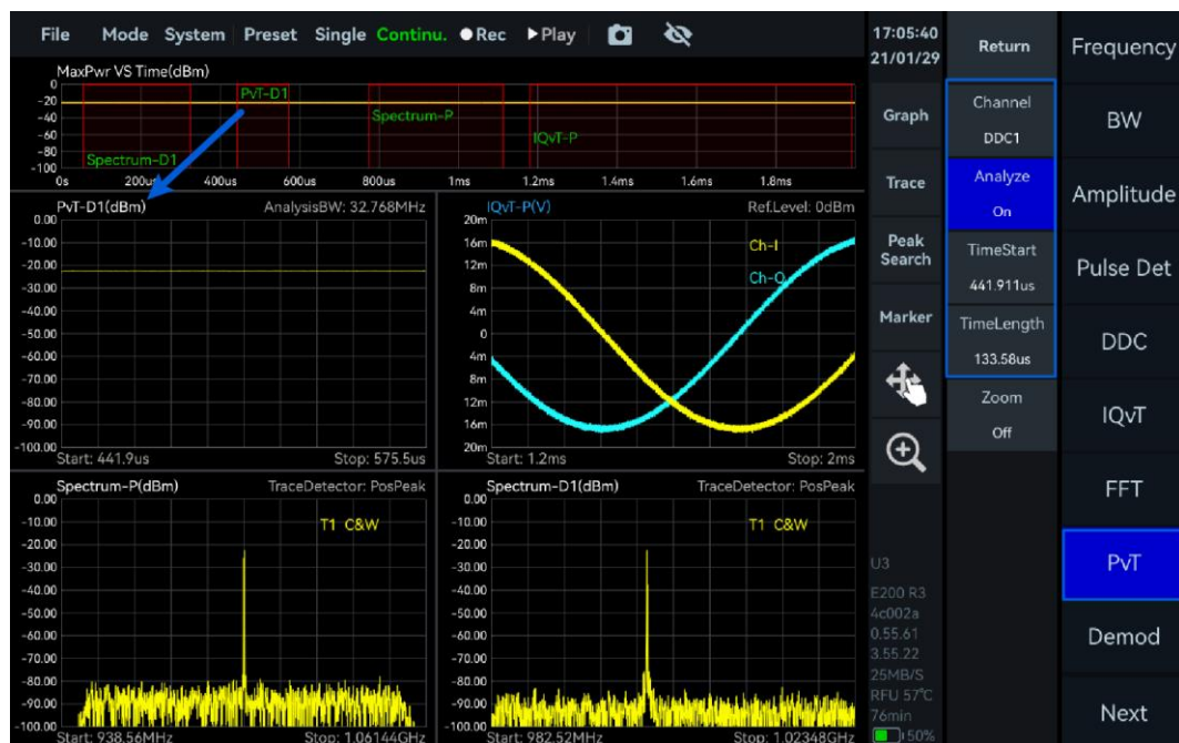
图 33 查看 DDC 下 IQ 子流的功率-时间图
