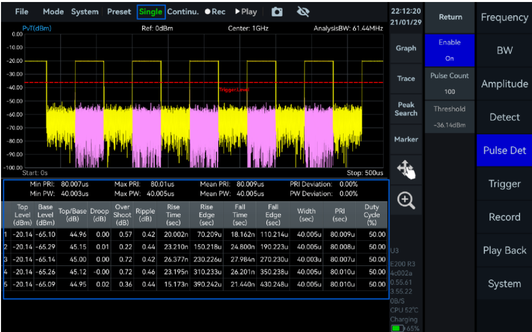
图 37 脉冲检测结果
