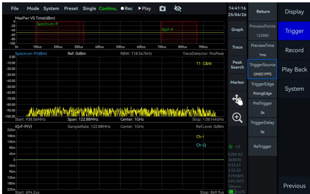
图 17 使用 GNSS 1 PPS 触发
