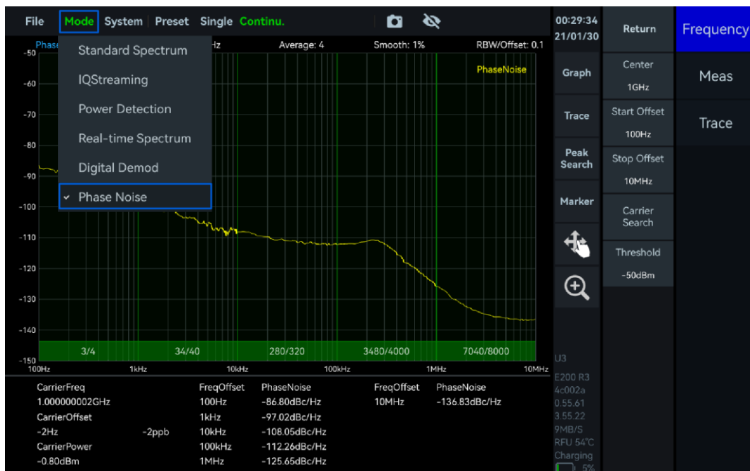
图 42 启用相位噪声测量功能
