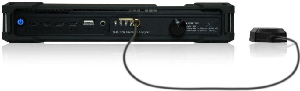
图 15 连接 GNSS 外部天线
