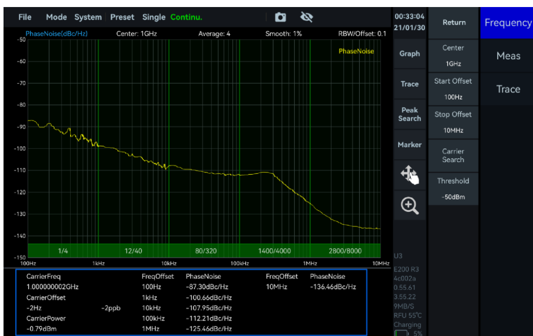
图 44 相位噪声测量结果
