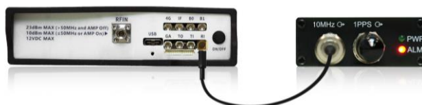
图 8 NXE/NXN-400 外部参考时钟连接示意图
