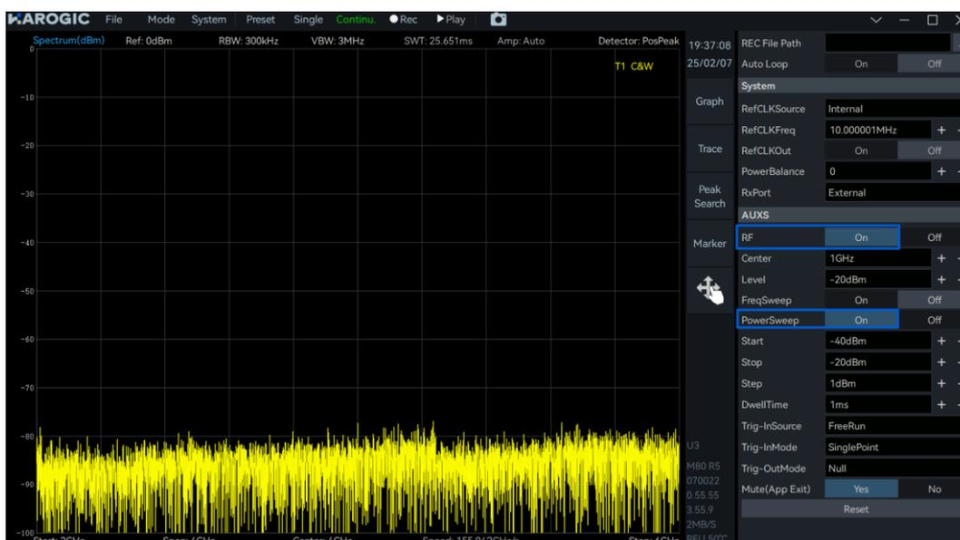
3. 在 “AUXS” 子菜单中，将 “Center” 设置为 1GHz，“Start” 设置为-40 dBm，“Stop” 设置为-20 dBm，“Step” 设置为 1 dBm，DwellTime 设置为 1 ms；
