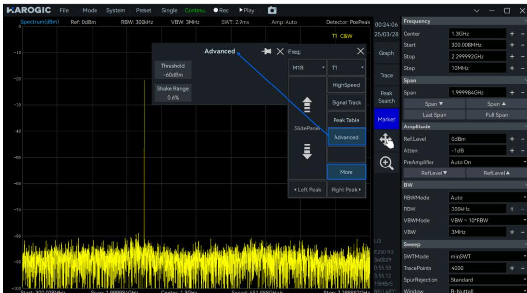
2. 点击“Signal Track”，参考游标在此时的扫宽内进行寻峰，并将此时的峰值信号对齐到中心频率位置，当目标信号的频率发生漂移时，仪器会自动调整自身的中心频率，使信号始终位于图表显示区的中心区域，方便用户观察和分析。
