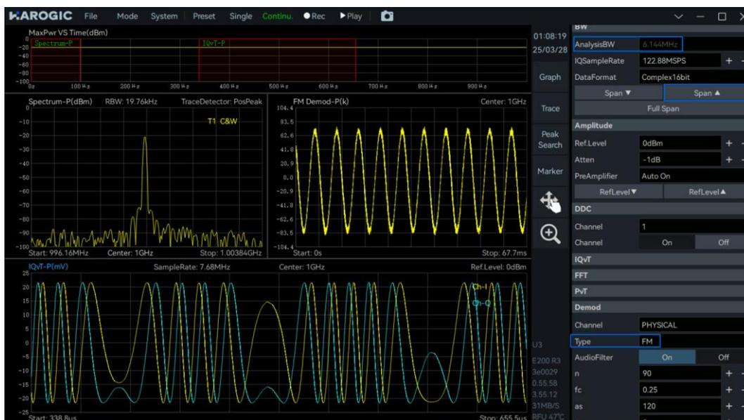
4. 收听 FM 广播信号时, 打开 “AudioFilter” (默认配置即可), 可对 FM 解调后的信号进行低通滤波, 减少部分高频噪声, 使收听的声音更纯净。
