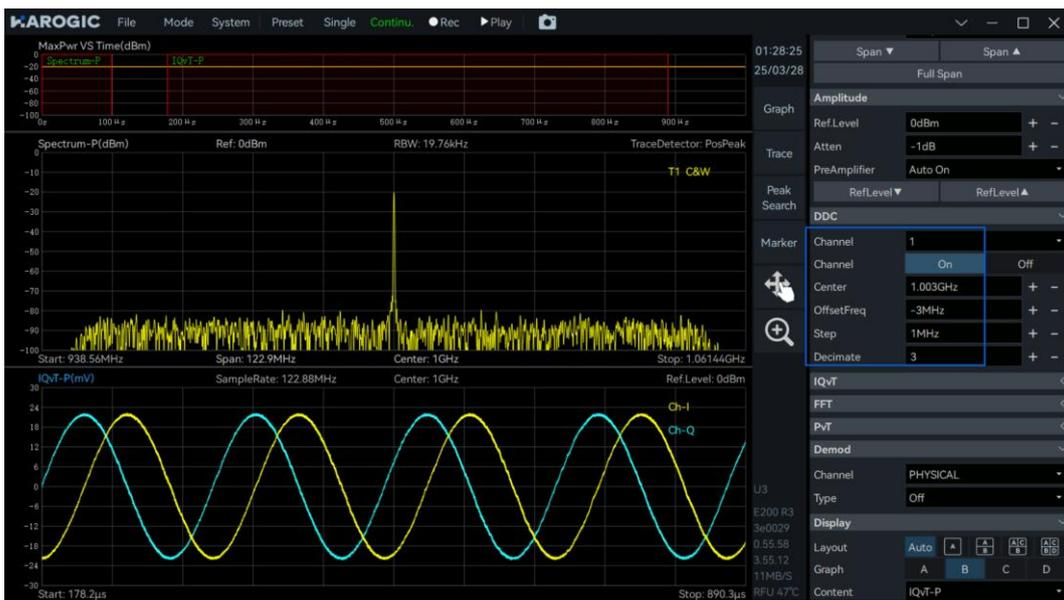
3. 在主设置区 “FFT” 模块的 “Channel” 下拉菜单中切换选择 “DDC1”, 打开 “Analyze”, 拖动最大功率时间缩略图中的 “Spectrum-D1” 红色缩选框, 或调整 “TimeStart” 和 “TimeLength” 的值, 可以对不同时间段 DDC 生成的 IQ 子流进行频谱分析;
