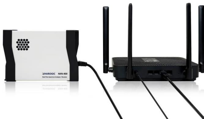
3. PC 端通过 WIFI 连接至同一个路由器，与仪器处于同一个局域网中，双击打开修改 IP 文件夹中 SetDeviceIPAddr.exe，可查看路由器分配给仪器的 IP 地址，本例中 IP 地址为“192.168.31.138”，用户
