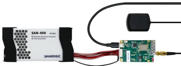
图 4 SAE/SAN-400 模块连接示意图
