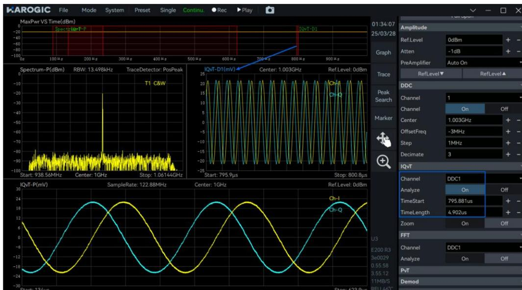
5. 在主设置区“PvT”模块的“Channel”下拉菜单中切换选择“DDC1”，打开“Analyze”，拖动最大功率时间缩略图中的“PvT-D1”红色缩选框，或调整“TimeStart”和“TimeLength”的值，可以对不同时间段 DDC 生成的 IQ 子流进行功率-时间分析。
