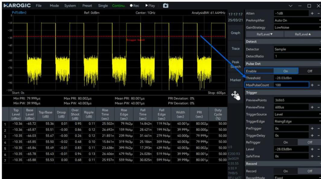
5. 点击菜单栏“Single”, 当前配置下的脉冲检测结果如下图所示。从图中可以得到每个检测到脉冲信号的峰值电平 (dBm)、基准电平 (dBm)、上升时间、上升沿、下降时间、下降沿、脉宽、周期和占空比等参数。以及所检测到脉冲信号的统计参数, 如: 最大、最小、平均脉冲周期和脉宽、周期偏差百分比和脉宽偏差百分比。
