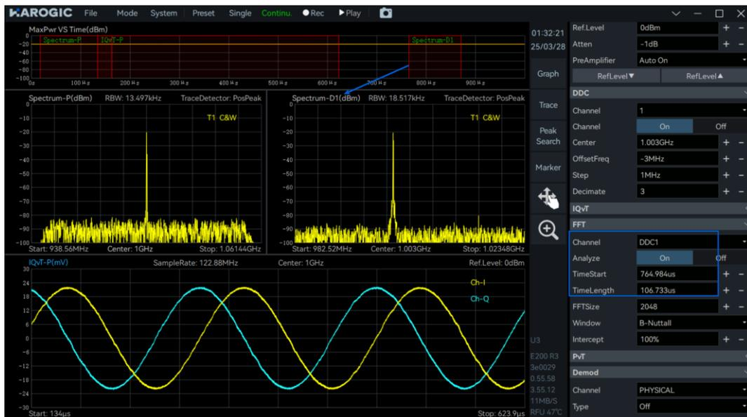
4. 在主设置区“IQvT”模块的“Channel”下拉菜单中切换选择“DDC1”，打开“Analyze”，拖动最大功率时间缩略图中的“IQvT-D1”红色缩选框，或调整“TimeStart”和“TimeLength”的值，可以对不同时间段 DDC 生成的 IQ 子流进行时域分析；
